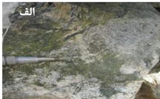
شکل ۱۸. (الف و ب): نمونه دستی رخداد دگرسانی پروپیلیتیک در سنگهای منطقه سرکوه
