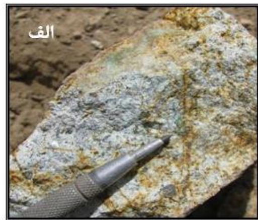
شکل ۱۷. الف و ب): قسمتی از رخنمون و نمونه دستی دگرسانی فیلیک (به تراکم رگچه‌های استوکورکی کوارتز-پیریت-سربیسیت)
