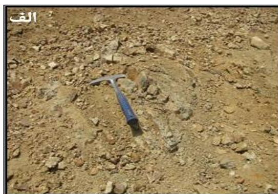
شکل ۱۵. الف و ب) : نمایی از رخداد دگرسانی پتاسیک در تعدادی از رخنمون‌های مجزای واحد سرکوه پورفیری (بیوتیت اولیه P-Bi و بیوتیت ثانویه S-Bi)
