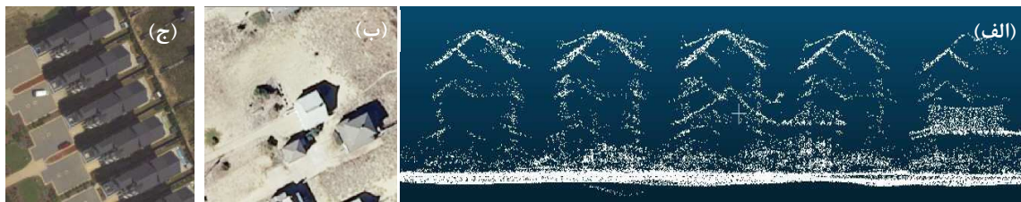
شکل ۴. تأثیر ترکیب دو ابر نقطه و ایجاد ابر نقطه واحد: ابر نقاط ترکیبی (الف)؛ عکس هوایی ۲۰۱۴ (ب)؛ عکس هوایی ۲۰۱۹ (ج)
