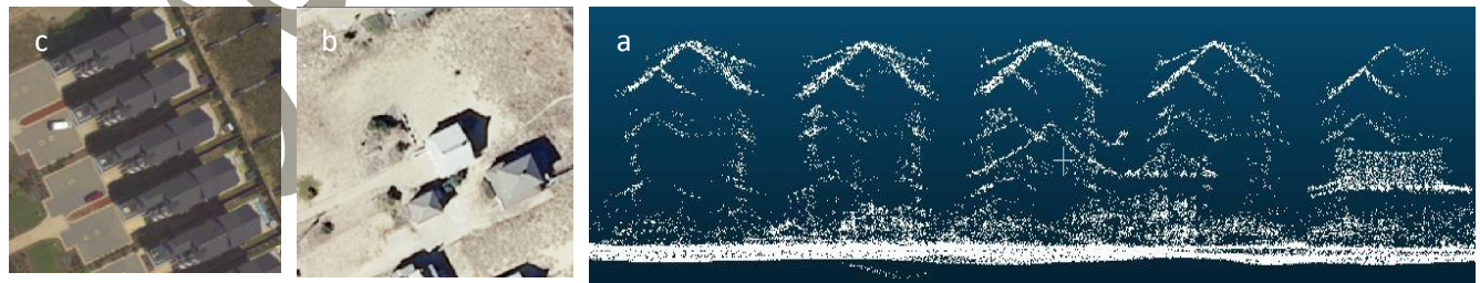
(شکل ۴) تاثیر ترکیب دو ابر نقطه و ایجاد ابر نقطه واحد (a) شکل سمت راست ابر نقاط ترکیبی (b) عکس هوایی ۲۰۱۴ (c) عکس هوایی ۲۰۱۹ در شکل ابر نقاط، دو ساختمان سمت چپ جدید می‌باشند اما ابر نقاط سه ساختمان سمت راست، با نقاط سه ساختمان قدیمی ترکیب شده و ابر نقطه با سطوح ارتفاعی متفاوتی برای هر نقطه برداشت شده ایجاد خواهند نمود.
