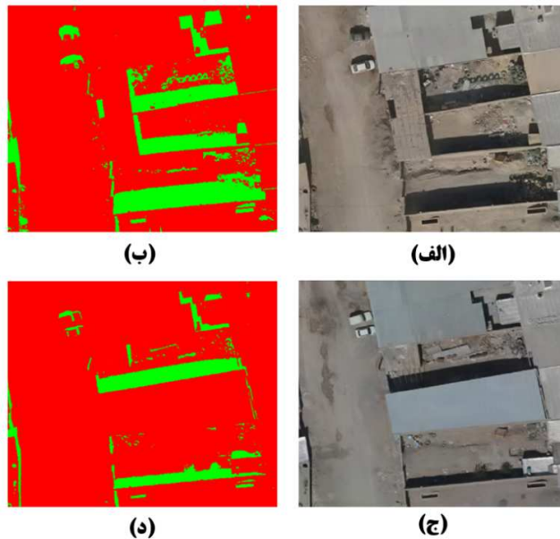
شکل ۹. شناسایی و حذف خطاها با کمک طبقه‌بندی تصویر. رنگ قرمز نشان‌دهنده پس‌زمینه و رنگ سبز نمایش‌دهنده سایه و پوشش گیاهی است. اثر سایه در منطقه مطالعاتی اول (شهر یزد) حذف می‌شود: تصویر زمان اول (اسفند ۱۳۹۹) (الف)؛ تصویر طبقه‌بندی زمان اول (ب)؛ تصویر زمان دوم (فروردین ۱۴۰۰). عارضه جدید با رنگ زرد مشخص شده است (ج)؛ تصویر طبقه‌بندی زمان دوم (د)
