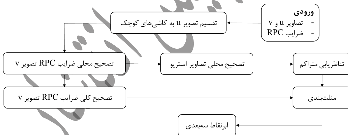
شکل ۶: ساختار کلی الگوریتم S 2 P (de Franchis et al., ۲۰۱۴)
