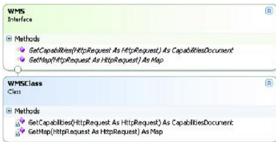
شکل ۲. دو عملیات یک سرویس WMS
