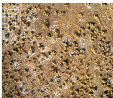
شکل ۲. الف) نصب سنجنده به زیر سکو؛ ب) تصویر گرفته‌شده توسط سنجنده در ارتفاع ۲۰ متری (مقیاس ۱:۱۵۰)
