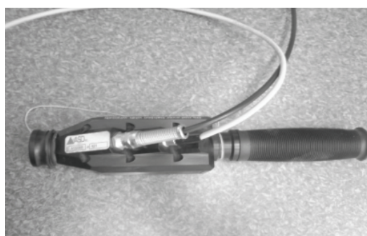
شکل ۳. دستگاه فیلداسپیک ۳ (سمت راست) و ابزار تکمیلی Contact probe (سمت چپ) (ابزار طیف‌سنجی موجود در گروه سنجش از دور و GIS دانشگاه شهید چمران اهواز)
