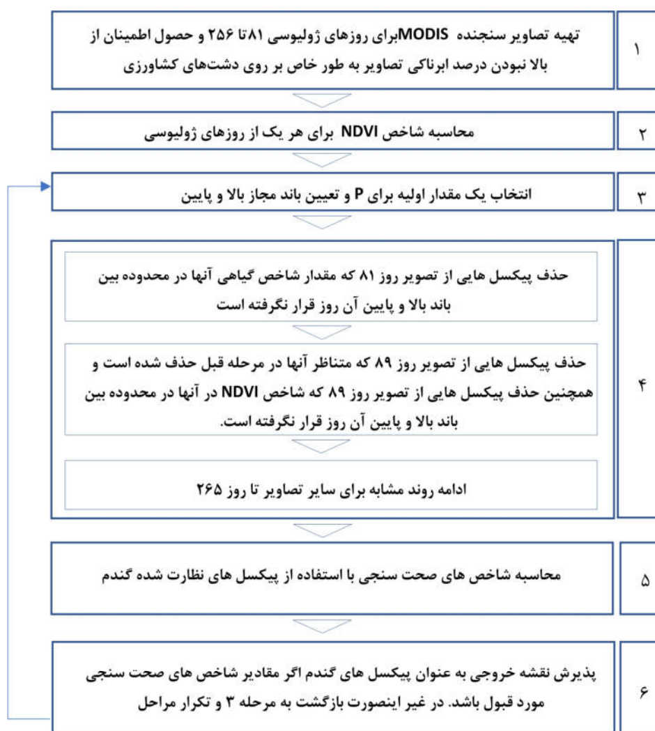
شکل ۲. الگوریتم تفکیک پیکسل‌های گندم در تصاویر مادیس، با استفاده از سری زمانی NDVI پیکسل‌های نظارت‌شده گندم
