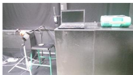
شکل ۲. چیدمان دستگاه طیف‌سنجی بازتابی پراکنشی آزمایشگاهی (LDRS) در اتاق تاریک
