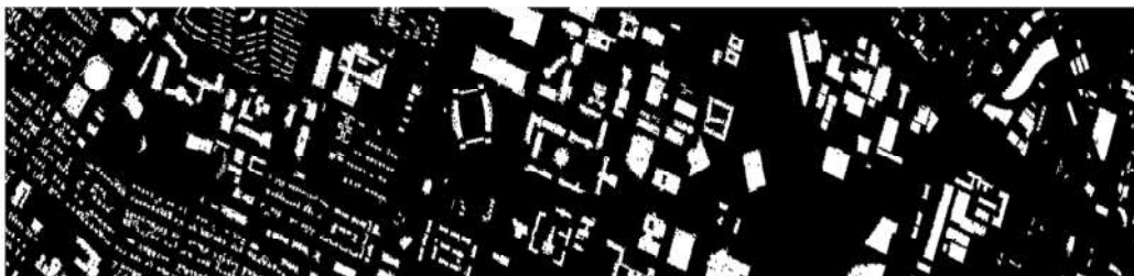
شکل ۵. عوارض ساختمانی استخراج شده به روش یادگیری ماشین روی تصاویر ابرطیفی و لیدار
