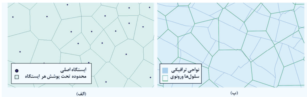
شکل ۱. تصویری از نواحی ترافیکی و محدوده تحت پوشش ایستگاه‌ها. (الف) ایستگاه‌ها اصلی و محدوده تحت پوشش هر ایستگاه؛ (ب) وضعیت نواحی ترافیکی و سلول‌های ورونوی
