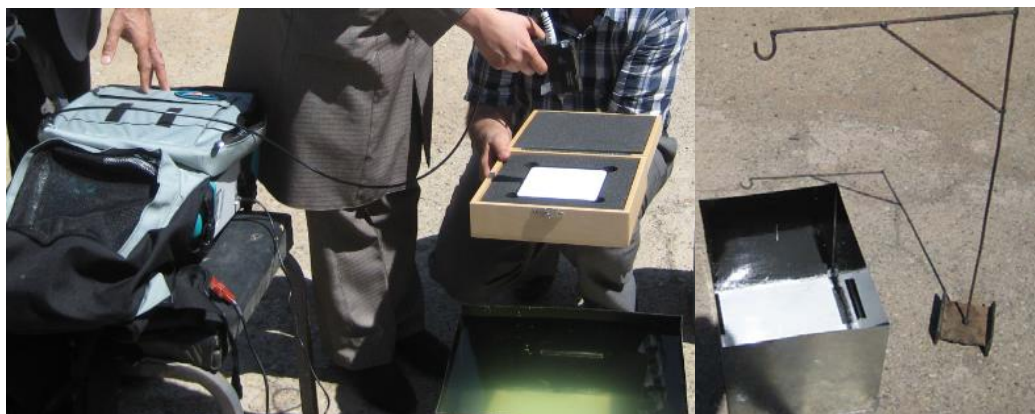
شکل ۲. مکعب ساخته‌شده برای نمونه‌برداری طیفی
