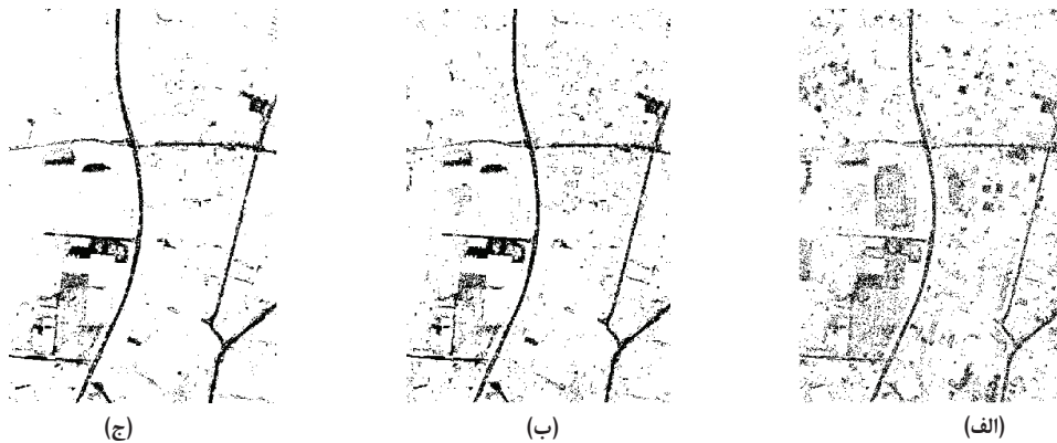
شکل ۱۳. راه‌های آشکار شده؛ (الف) اعمال طبقه‌بندی SVM روی داده‌های شدت، (ب) اعمال طبقه‌بندی SVM روی داده‌های شدت و فاصله، (ج) به‌کارگیری لایه DNTM
